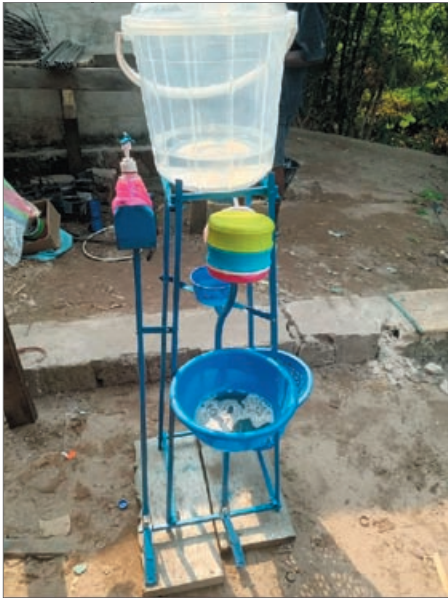
Fußpedalbetriebene Handwaschvorrichtungen, die Joseph herstellt. R: Eine Bestellung der UNICEF für den Osten der DR Kongo.
