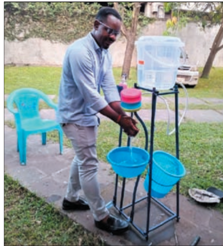
Fußpedalbetriebene Handwaschvorrichtungen, die Joseph herstellt. R: Eine Bestellung der UNICEF für den Osten der DR Kongo.
