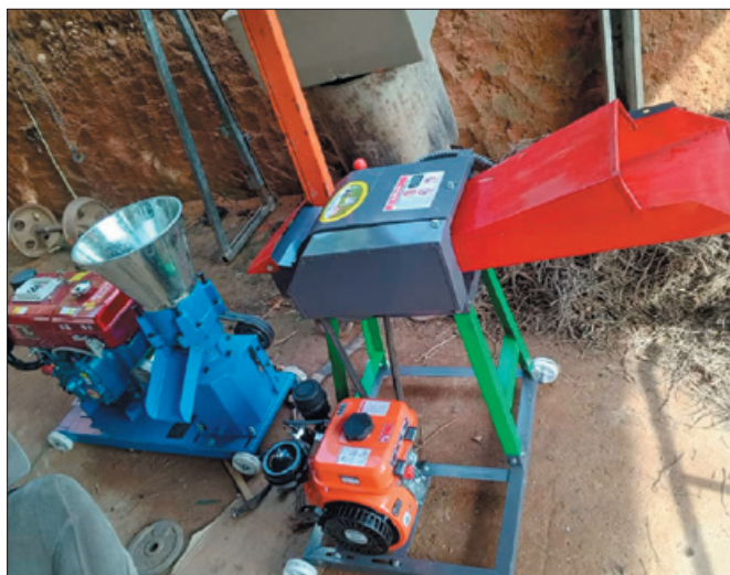
Stroj na výrobu pelet pro krmení zvířat a ryb. Druhý je na mletí trávy pro hospodářská zvířata.
