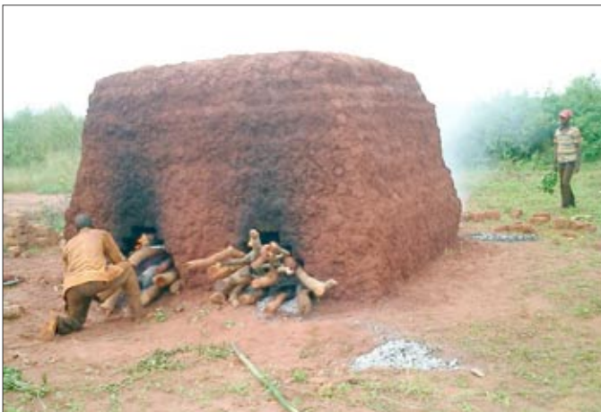
Un nouveau four pour brûler les briques et les rendre plus solides
