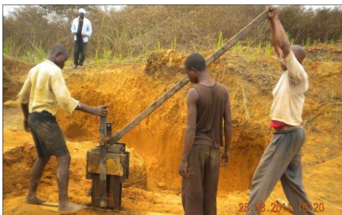
Presse manuelle pour la fabrication de briques : de la terre glaise et de l'huile. Après avoir été cuites, les briques deviennent solides.
