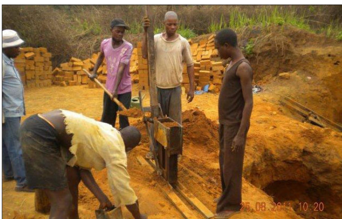
Presse manuelle pour la fabrication de briques : de la terre glaise et de l'huile. Après avoir été cuites, les briques deviennent solides.
