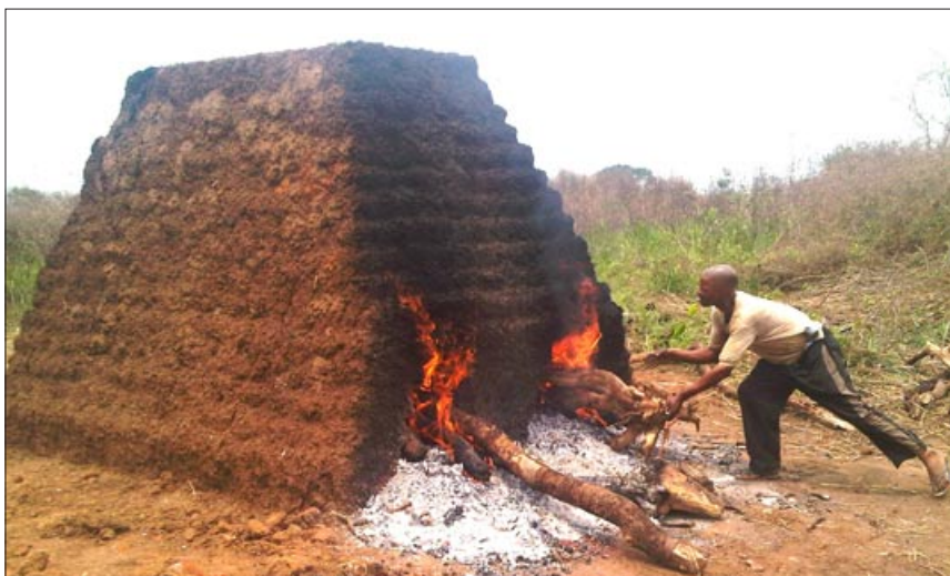
Un simple four fait de briques, de l'argile autour et un feu à l'intérieur
