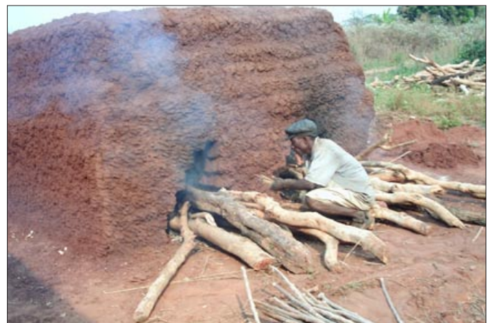
Ziegel zu einem Ofen aufgetürmt mit 2 Öffnungen. Nach Lehmabdeckung kommt Feuer rein und wird dann versiegelt.
