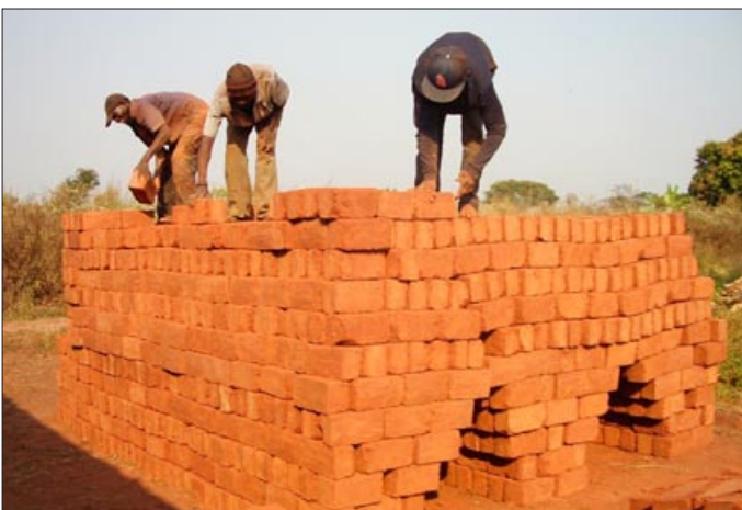
Ziegel zu einem Ofen aufgetürmt mit 2 Öffnungen. Nach Lehmabdeckung kommt Feuer rein und wird dann versiegelt.
