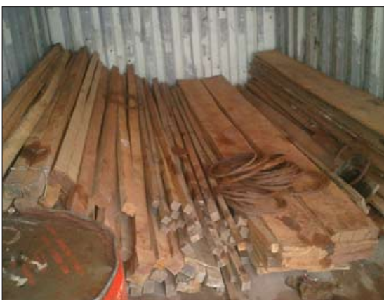
Dřevěná prkna a trámy na střešku, dveře atd. Železné pruty do základů a do sloupů. Vlnitý plech na střešku.
