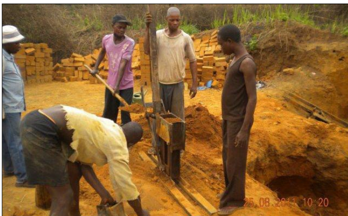
Nástroj pro ruční výrobu cihel: hlína, trochu oleje a dřiny. Po vypálení jsou velmi pevné
