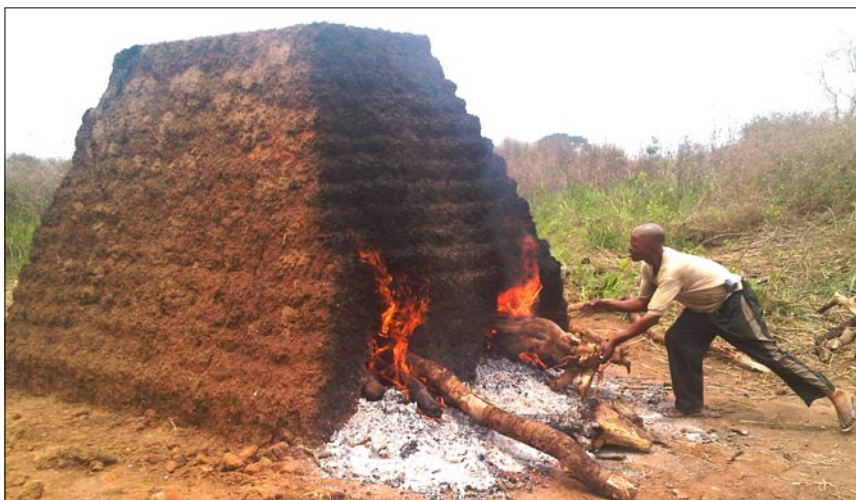
Jednoduchá cihlářská pec: cihly pokryté hlínou a uvnitř oheň
