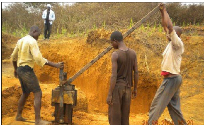
Nástroj pro ruční výrobu cihel: hlína, trochu oleje a dřiny. Po vypálení jsou velmi pevné
