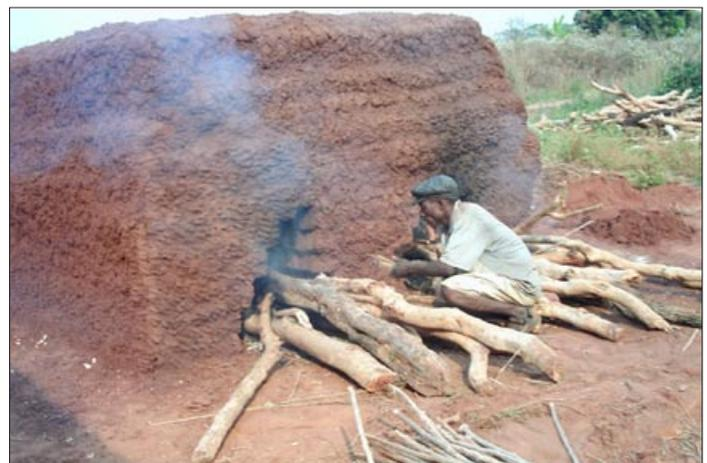
*Briques étant empilées au four avec 2 ouvertures. Après être couvert de glaise, le feu est allumé à l'intérieur et ensuite le four scellé*
